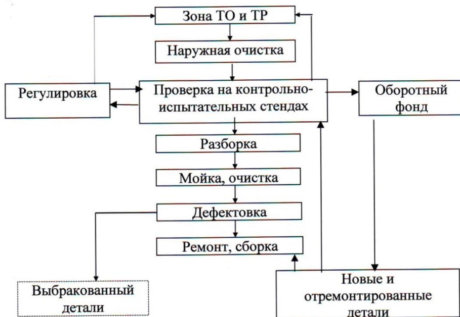
Схема технологического процесса цеха ремонта топливной аппаратуры
